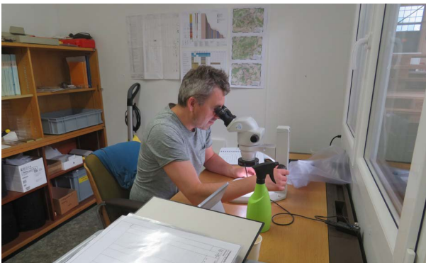
Beschreibung von Bohrkleinproben (Cuttings) der Bohrung Bülach am Binokularmikroskop
